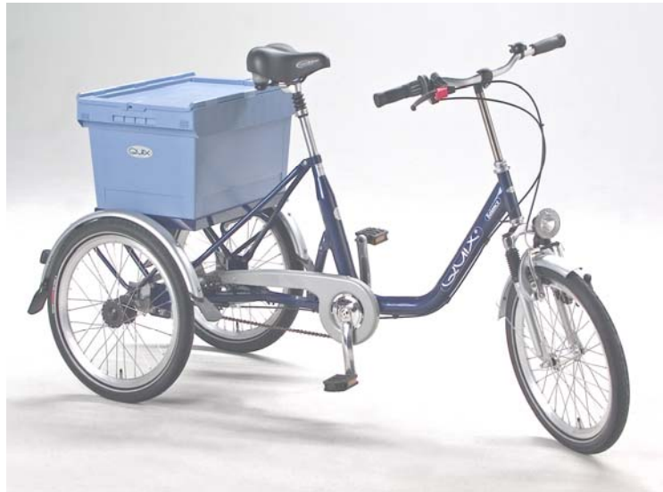
Auf der Abbildung: Quix Balance mit Federgabel, gefederter Sattelstütze und Gepäckbox
